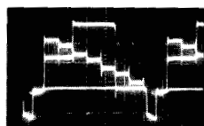
2. IC601 Pin 52 (E-PCB) Y In 0.7V, 20 \mu s / Div
