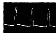
10. FBT Pin 4 (E-PCB) 237V, 20 \mu s / Div
